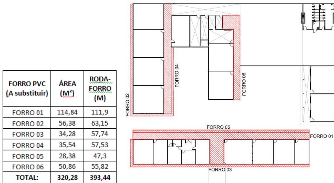
Figura 06 – Forros a substituir
